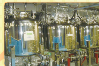
バッチブレンド装置
