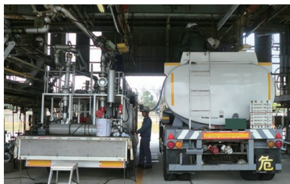
【流量計器差試験配管構成】
