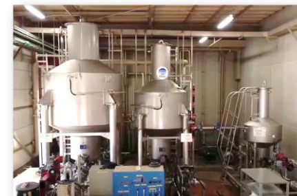
水校正設備【JCSS校正】 基準タンク
