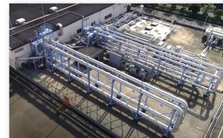
石油校正設備【JCSS校正】 パイププルーバ
