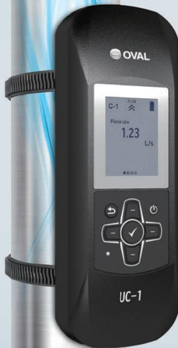
一般的に一体型のクランプオン形超音波流量計では1機種1～2口径の計測が可能となっていますが、UC-1はセンサ位置スライド機構により、1機種で25～100Aの8口径(25、32、40、50、65、80、90、100A)を計測可能です。
