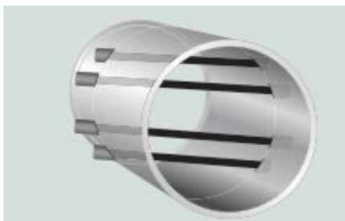
流量計内部模式図 (センサ並びに超音波伝搬経路)
