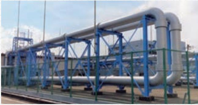
パイプルーバーは石油用流量計の試験や校正のための設備で、当社の精度管理の中核を担う設備となります。
