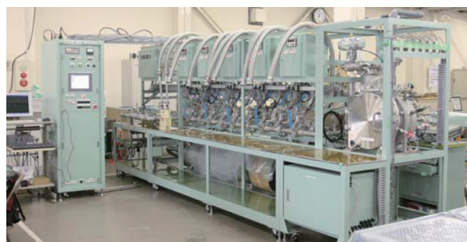
ガスメータ複数台を直列に接続し同時に試験可能とした設備
