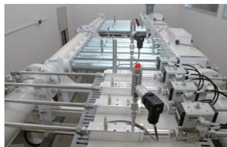
圧力・温度センサ付 ISO 準拠 SV 整流管筐体
