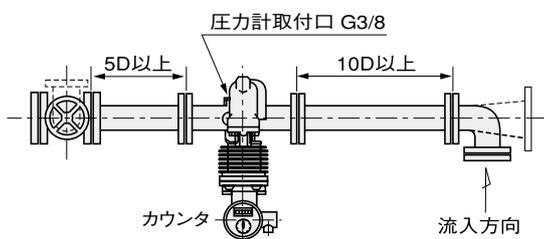
注：カウンタ面は配管条件に応じ90°ステップで取り付け変更が可能です。
