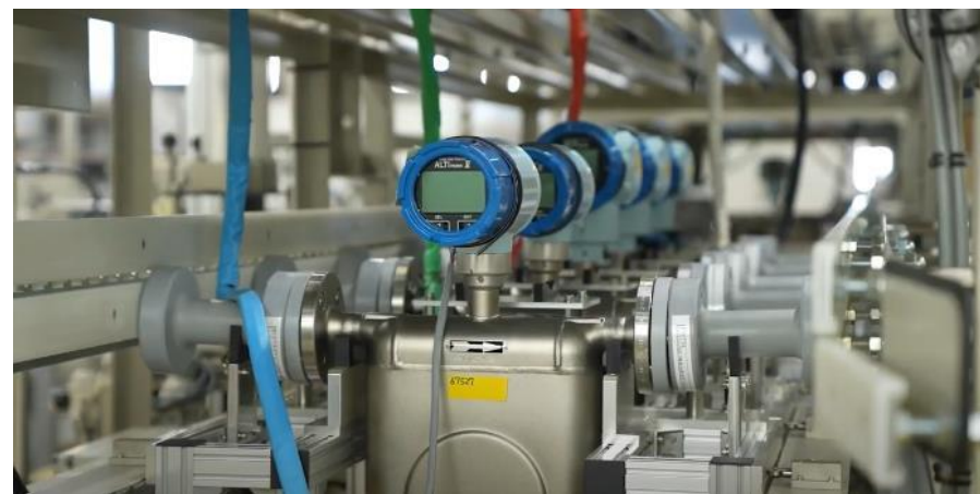
コリオリ流量計自動検査装置
